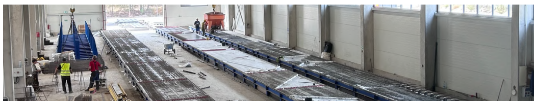
We manufacture and install tables up to 50.00 meters in length in a single segment. Produjemy i montujemy blaty robocze o długości nawet 50,00 m w jednym segmencie.
