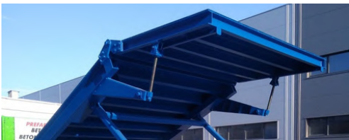
Adjustment of the angle of inclination of the resting points. Regulacja kąta nachylenia spoczników.
